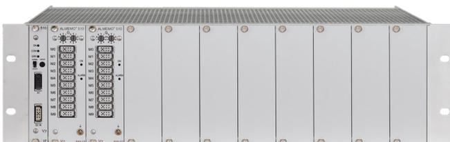
Messwerterfassungsanlage im 19“-Baugruppenträger,
